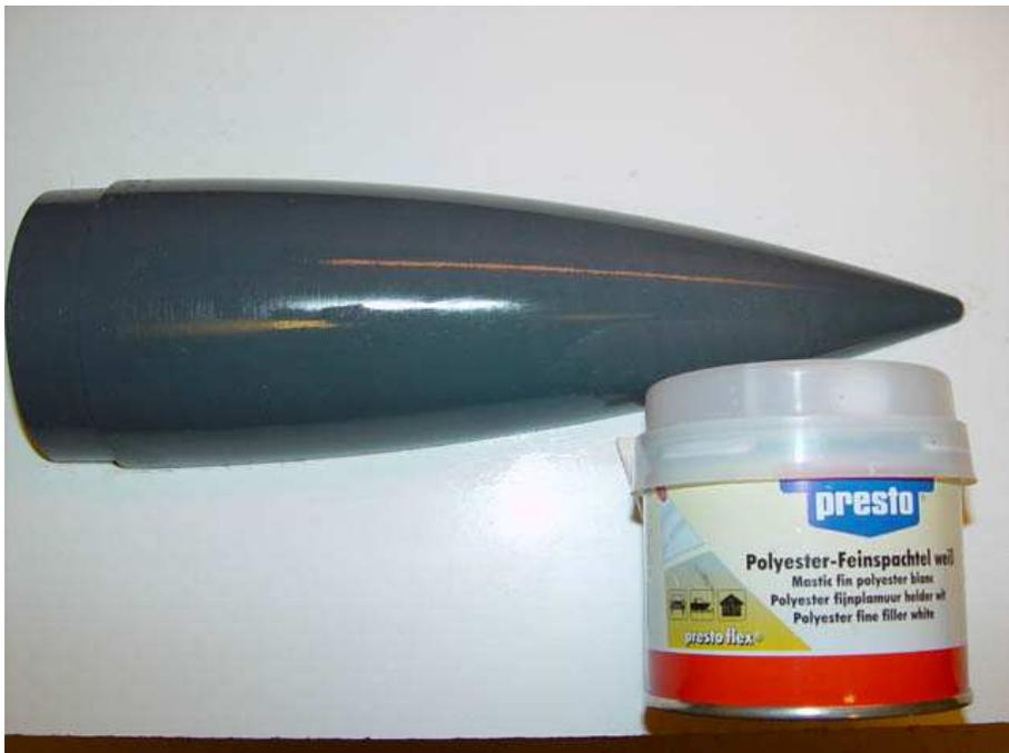
**Schritt 5:** Die Spachtelreste werden von der Modellspitze fein säuberlich entfernt. Dann schneidet man aus Balsaresten ein Brettchen und 3 Leisten sowie ein dreieckiges Stützbrettchen für die Umrahmung der Formfläche aus.
