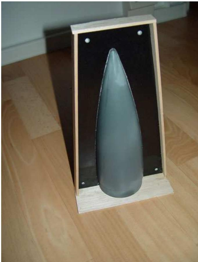
**Schritt 14:** Die gesamte Oberfläche (Modellspitze + Formenhälfte) gut mit Folientrennmittel isolieren.
