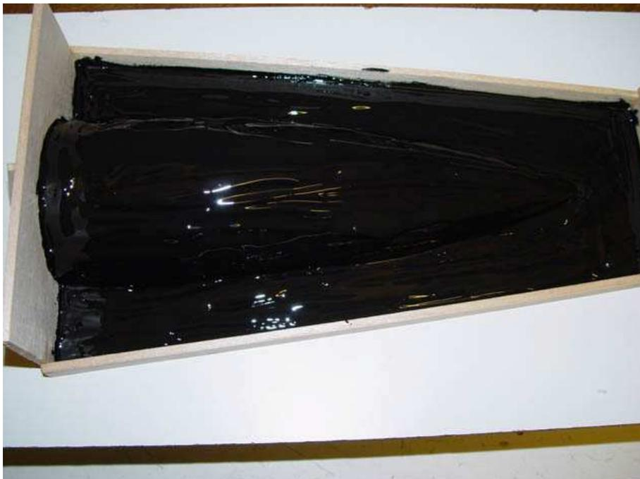
**Schritt 10:** Bevor das Formenharz richtig aushärtet, wird nun eine Lage Glasfasern mit Laminierharz aufgebracht.
