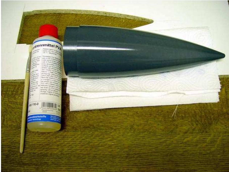
**Schritt 4:** Ist die Modellspitze isoliert, wird sie in das Trennbrett eingesetzt und die umlaufende Fuge mit Polyester- Feinspachtel sauber und glatt zugespachtelt.
