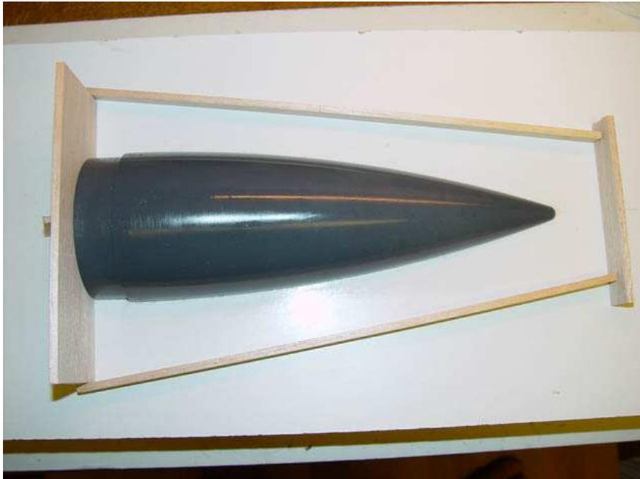
**Schritt 6:** Jetzt werden die Balsaleisten mit Sekundenkleber auf das Trennbrett aufgeklebt. Vorher sollte man die Positionen mit Bleistift anzeichnen. Das dreieckige Stützbrettchen wird so geklebt, daß es das stirnseitige Brettchen sauber an die Fläche der Modellspitze anpresst. Wenn alles fest ist, wird die Spitze und die Trennebene wieder gut mit Folientrennmittel isoliert.
