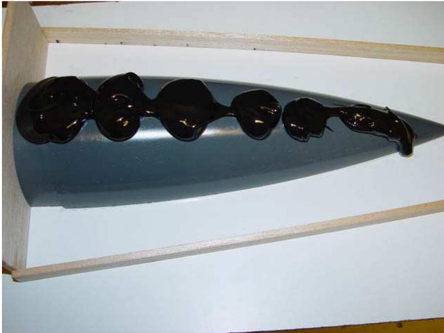
**Schritt 9:** Mit einem Pinsel wird das Formenharz nun langsam und gleichmäßig über die gesamte Oberfläche verteilt, sodass eine 2 - 3 mm dicke Schicht entsteht. Das Formenharz neigt nicht dazu, Luftblasen einzuschließen, trotzdem sind alle Kanten und Ecken sorgfältig mit dem Pinsel anzutupfen. Das Formenharz braucht nun 2 - 4 Stunden Gelierzeit.
