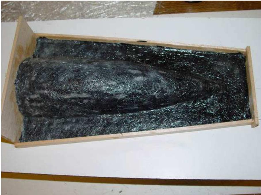
**Schritt 11:** Nachdem drei Lagen Glasmatte und eine Lage Gewebe als Abschluß aufgebracht und ausgehärtet sind, schneidet man die Balsaleisten ringsherum mit einem scharfen Messer vom Trennbrett ab.
