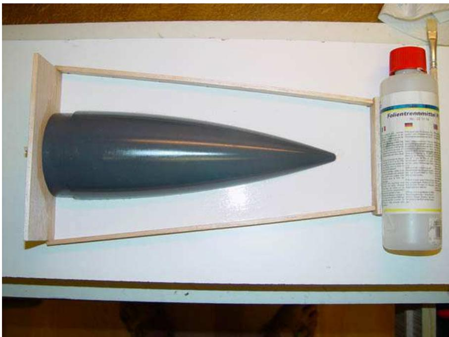
**Schritt 7:** Jetzt wartet man, bis das Folientrennmittel gut abgetrocknet ist. Dann nimmt man das Formenharz und den Härter und mischt beides exakt nach Vorschrift 100 Teile Harz und 17 Teile Härter.
