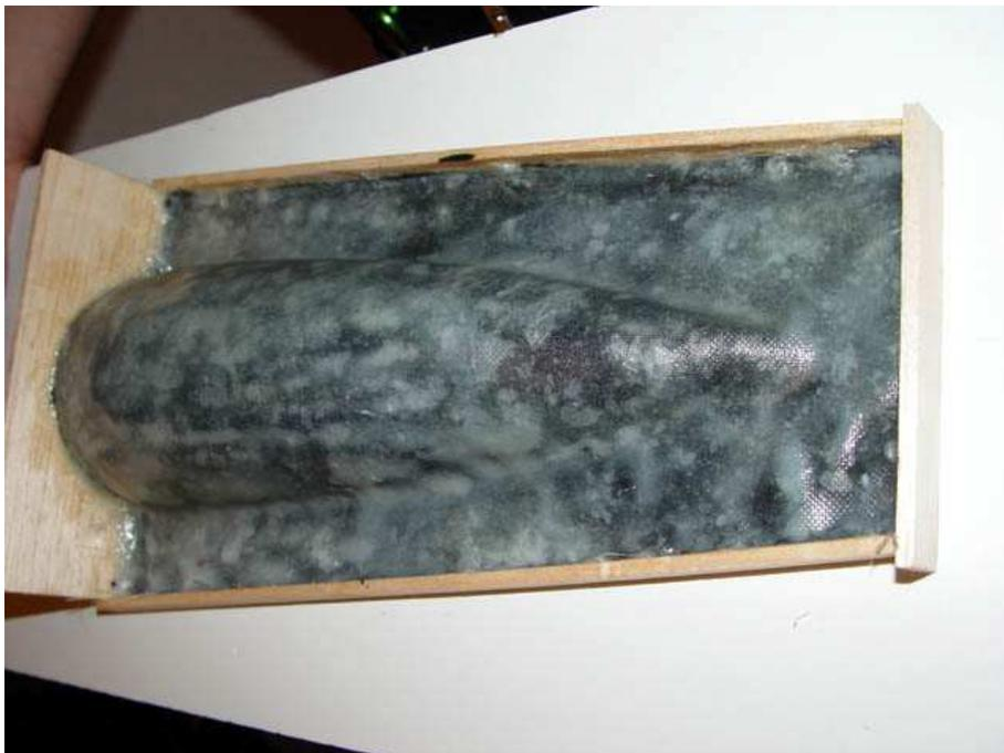
**Schritt 12:** Nun wird das Ganze vom Trennbrett abgelöst. Dieses wird nun nicht mehr gebraucht. Die Fläche muß gut von Spachtel- und Trennmittelresten befreit werden. Die Balsaleisten werden entfernt. Wenn alles von Balsa und Trennmittelresten befreit ist, werden in den Ecken 4 Ansenkungen gebohrt, damit die Hälften der Form später wieder exakt zusammengefügt werden können. Der Formenspezialist verwendet hier Passstifte und Hülsen - ist mir aber zu aufwändig und diese Methode hat sich bewährt.
