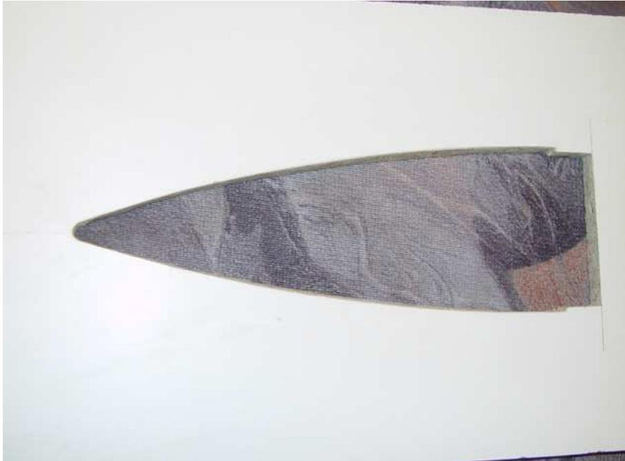
**Schritt 2:** Dann wird der Sägeschnitt solange beschliffen, bis die Modellspitze exakt bis zu deren Mitte in die Platte passt.
