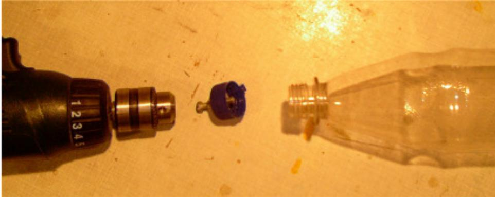
Die Flasche wird mit dem Deckel, worin eine Gewindestange mit Unterlegscheiben und Muttern geschraubt ist, an dem Akkuschauber befestigt. Somit kann sich die Flasche frei drehen.
