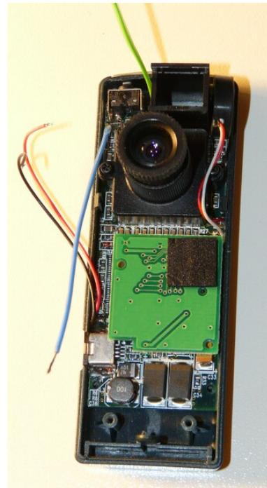
An die Kontakte des Batteriefaches kommt jeweils ein neues Kabel, welches nach draußen geführt wird. Das schwarze Kabel (Minuspol) der Platine wird wieder an den Batteriekontakt gelötet. An das rote Kabel, von der Platine kommend, wird ein Kabel als Verlängerung angelötet und auch nach draußen geführt. Sind alle Kabel nach draußen geführt kann das Batteriefach festgeschraubt werden.
