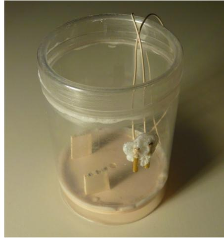
Zur seitlichen Stabilisierung sind Holzstücke vorgesehen und ein Schwamm hält die Kamera in Position. An der Außenseite befinden sich zwei Messingröhrchen die als Abreißkontakt gedacht sind. Dort hinein wird eine Drahtbrücke gesteckt und kurz vor dem Start abgezogen als Signal für den Mikrocontroller.
